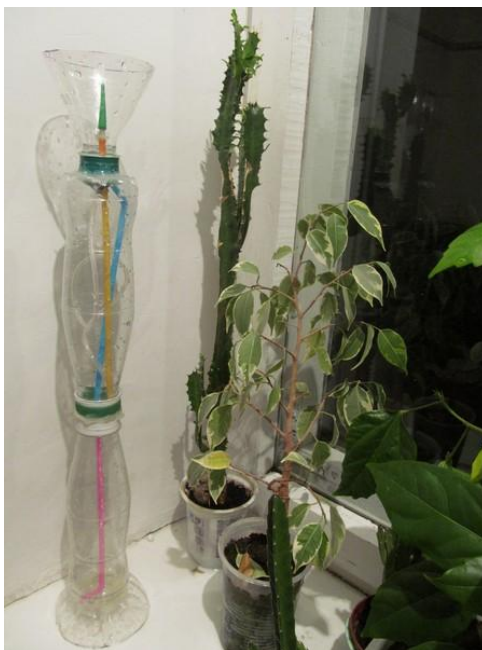
Рисунок 1 – Готовый макет фонтана Герона
